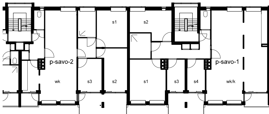
portiekwoningen blok B1 (huur, samenvoeging van 3 naar 2))
